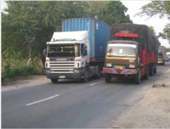
▲ Tanpa adanya bahu jalan yang diperkeras, gerakan mendahului (overtaking) memiliki risiko yang besar bagi kendaraan dari arah berlawanan yang terdesak ke luar jalan. Hal ini merupakan penyebab utama terjadinya tabrakan depan-depan dan tabrakan keluar jalan
