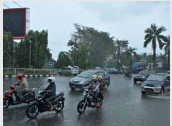
▲ Saat air tidak langsung mengalir ke luar dari jalan dan menggenang di atas perkerasan, ada risiko mengapung. Ini berbahaya terutama bagi sepeda motor.
