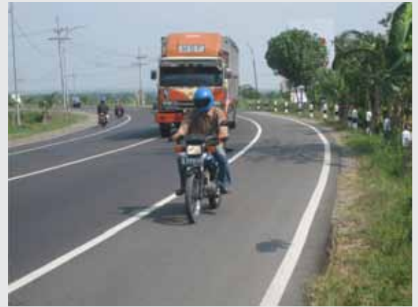
▲ Jalan yang bebas dari lubang, marka yang jelas dengan bahu diperkeras memiliki risiko tabrakan keluar jalan yang rendah.
