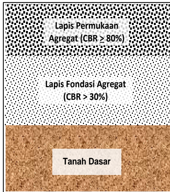
Gambar 9.1 Lapisan struktur perkerasan berbutir
