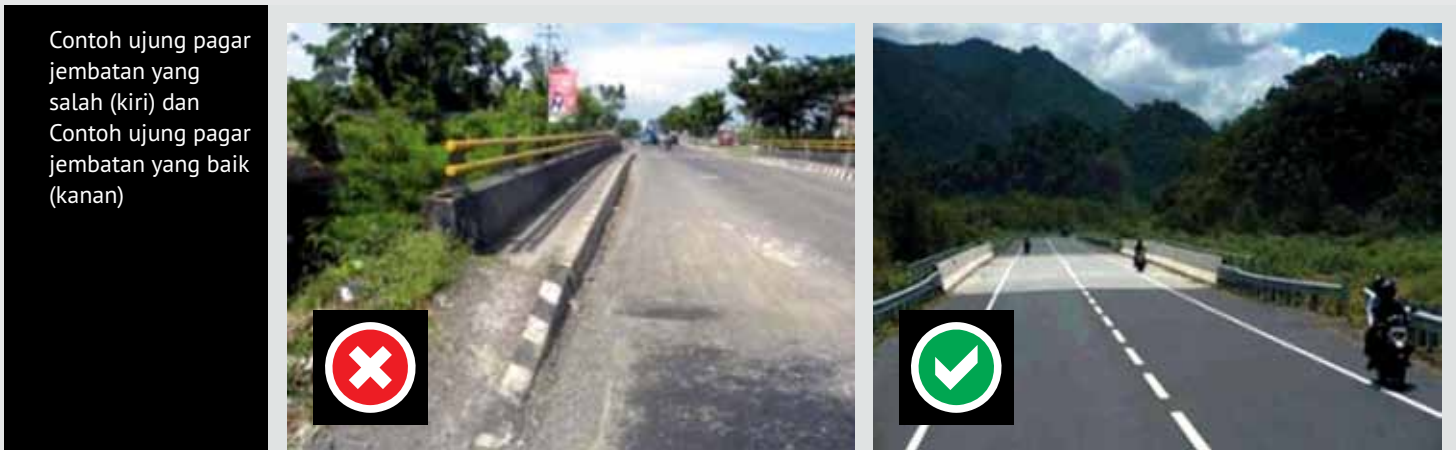
Gambar 1.3 Contoh hazard sisi jalan di ujung jembatan yang salah dan benar
