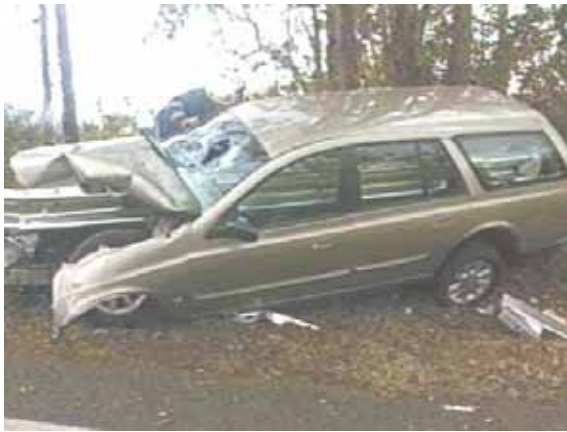
Gambar 3.18 Terminal yang tidak aman dapat membunuh dan menghancurkan kendaraan.
