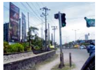
Melindungi aset dengan tiang atau beton akan meningkatkan jumlah bahaya sisi jalan. Hal ini meningkatkan kemungkinan kecelakaan, dan dalam beberapa kasus, meningkatkan keparahan tabrakan.
